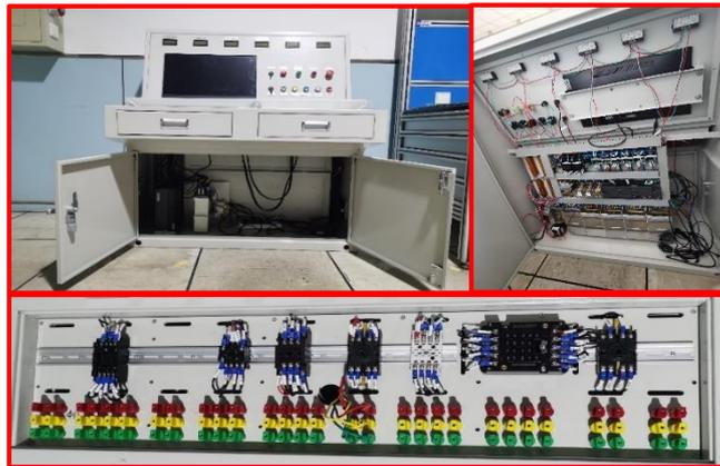
图1 继电器智能预测性维护系统
